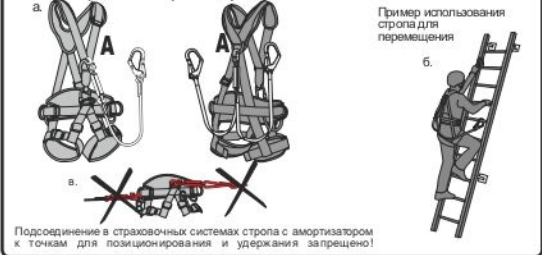
Рис. 6. Использование карабинов, входящих в состав стропов
