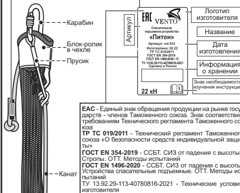
Рис. 1. Состав и маркировка изделия
