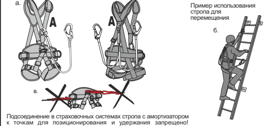
Рис. 6. Использование карабинов, входящих в состав стропов
