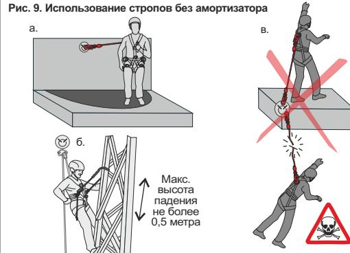
**Амортизатор** (ГОСТ Р ЕН 355-2008) — отдельная деталь или компонент страховочной системы, предназначенный для рассеивания кинетической энергии, развиваемой при падении с высоты.
